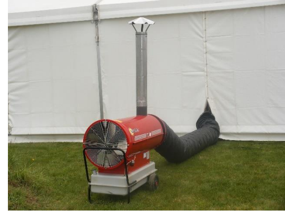
Générateur à air chaud au fuel
